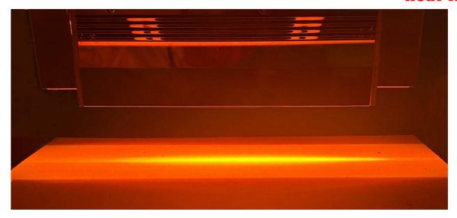
Bata tahan api disinari dengan HLH-65W/f75/L280 dari jarak pengenal 75mm.
