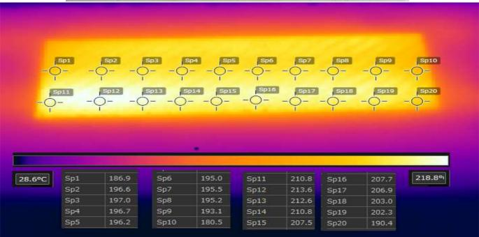
【 Heating of carbon fiber sheet 】
