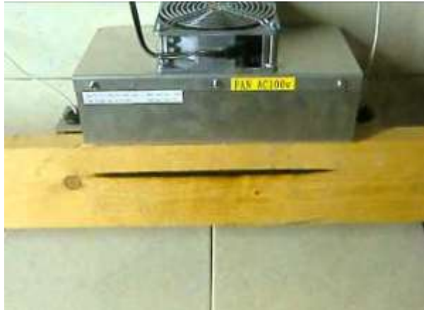
【Line heating of wood】
