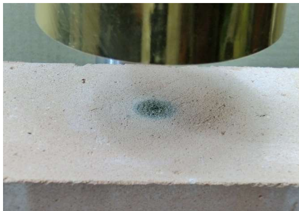
【 The scorch of refractory bricks 】
